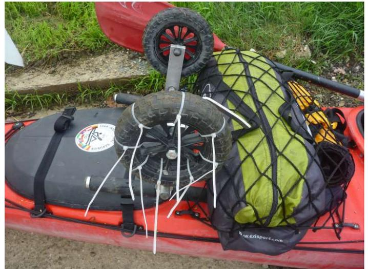
Ausserdem sind laufend die Vollgummi Reifen von der Felge abgerutscht und konnten nur mit Plastikband oder Osolierband für kurze Zeit benutzt werden.
